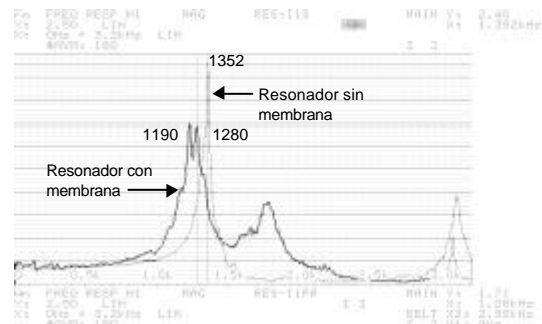
Fig. 7. Comportamiento de un prototipo de resonador de rendija a escala 1:10 con y sin membrana elástica superior
