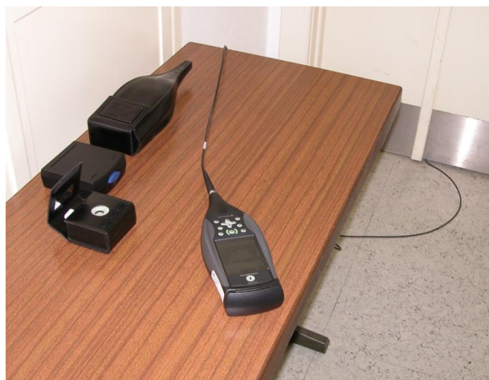
Figura 3 – Medição com sonómetro e operador fora da sala
