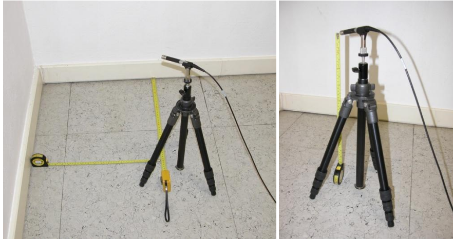
Figura 4 – Colocação do microfone numa posição de canto
