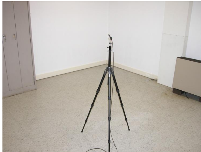
Figura 5 – Colocação do microfone numa posição de campo reverberante
