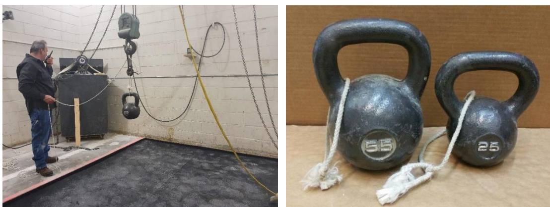
Figura 1 – (izq.) Suspensión típica de las pesas a ensayar, encima del modelo de ensayo. (dcha) Pesas rusas de fundición utilizadas en los ensayos de caída libre de pesos en laboratorio.
