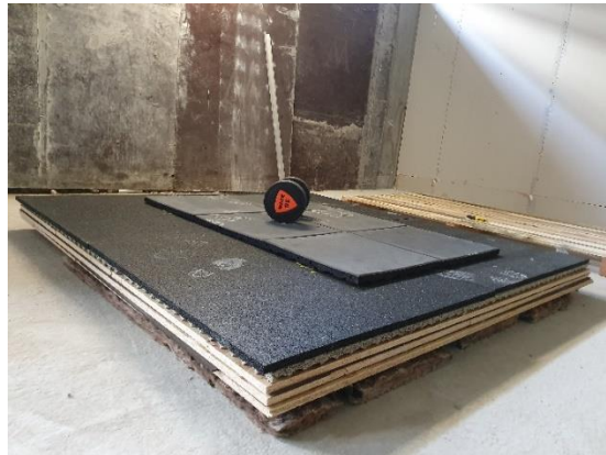
Figura 2 – Sistema de suelo flotante aligerado durante un ensayo in situ.
