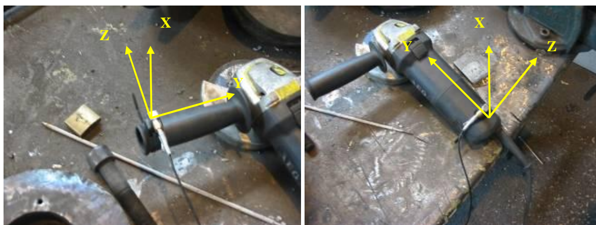
Figura 3 – Exemplo de montagem de acelerómetro triaxial em rebarbadora para medição de vibrações para mão esquerda e mão direita.
