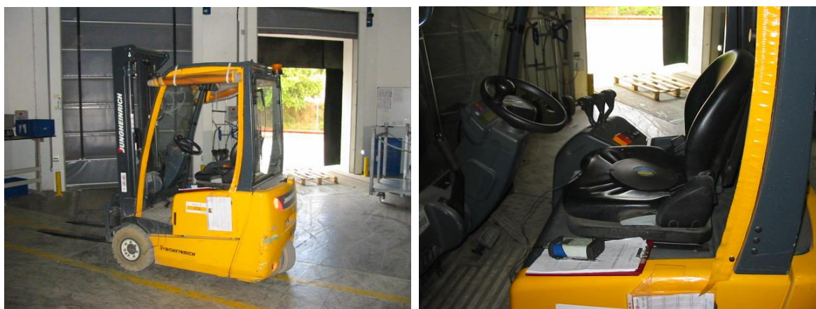
Figura 5 – Exemplo de medição das vibrações transmitidas ao corpo inteiro num empilhador eléctrico.
