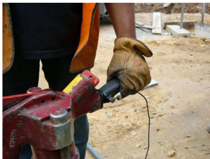
Figura 4 – Exemplo de medição das vibrações transmitidas para a mão esquerda do operador de martelo pneumático.
