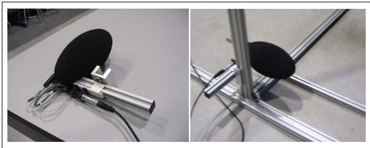
Figura 1 – Pantalla antiviento colocada en la sonda de intensidad
