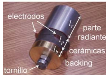
Figura 5 – Transductor sándwich con una frecuencia de resonancia de unos 60 kHz.
