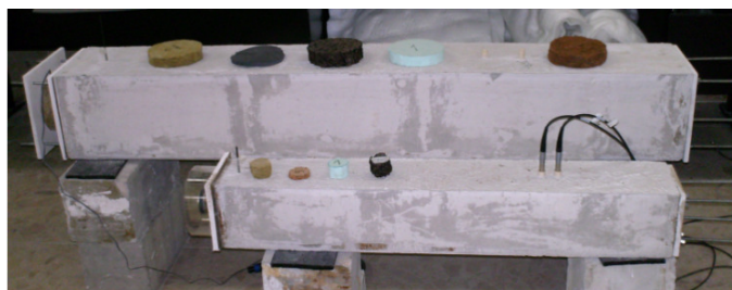
Figura 2: Fotografia dos tubos de impedância, após construção e montagem.
