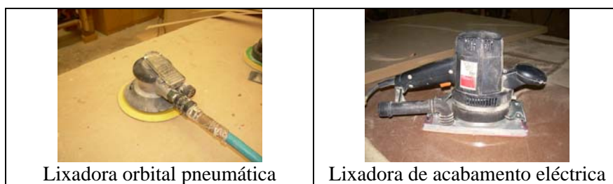
Figura 1 – Principais ferramentas caracterizadas referentes à transmissão de vibrações ao sistema mão-braço no Sector da Madeira e do Mobiliário
