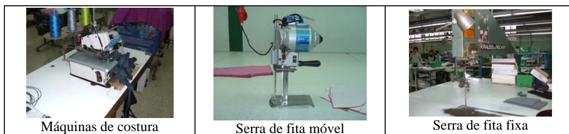
Figura 3 – Ferramentas caracterizadas referentes à transmissão de vibrações ao sistema mão-braço no Sector Têxtil e do Vestuário
