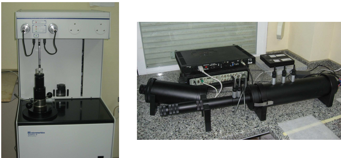
Figura 1 – Detalle del porosímetro de intrusión de mercurio (izqda.) y tubo de impedancia (dcha.) utilizados.
