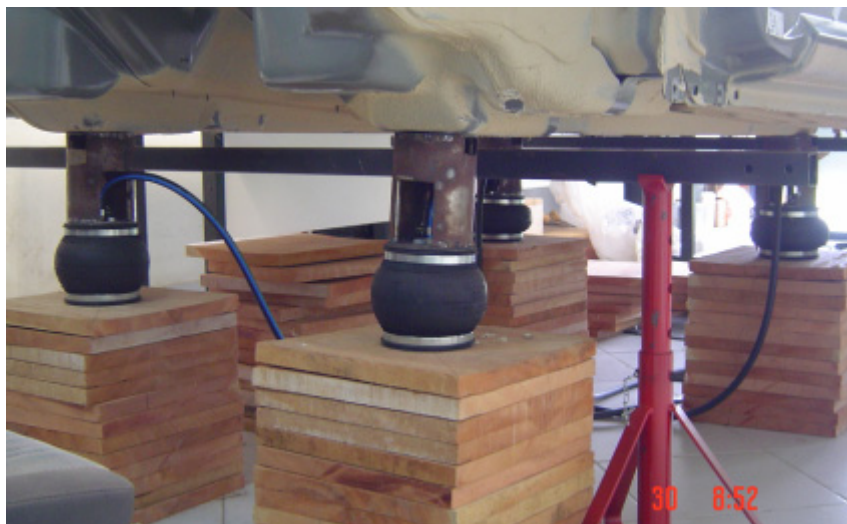
Figura 4. Sistema de isolamento utilizado no experimento.
