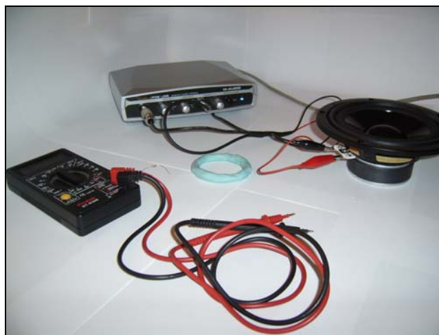
Ilustración 1: Kit de medición utilizado para la medición de parámetros T-S
